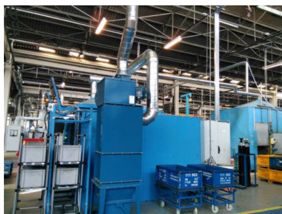
Figura 42 - Sistemas de filtragem de extrações de soldadura 1, 2, 3 e 4.
