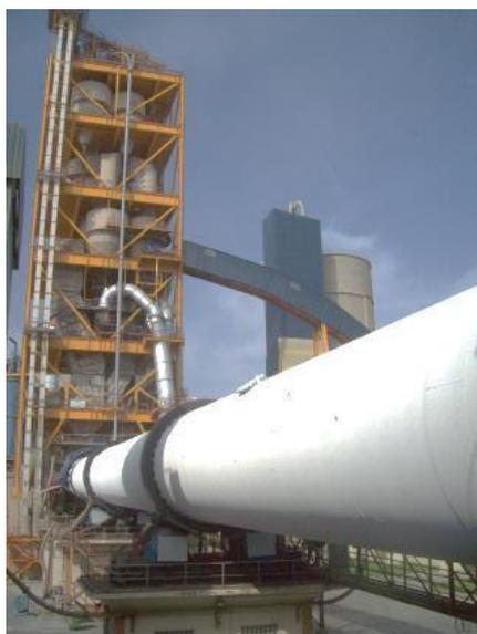
Forno e torre de pré-aquecimento em etapas da linha 7 (MTD 7) a qual será sujeita a um processo de upgrade/modernização nos próximos anos
