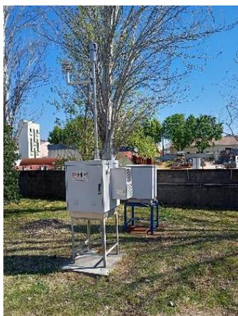
Novo analisador para monitorização das partículas em suspensão (PM<sub>10</sub>)
