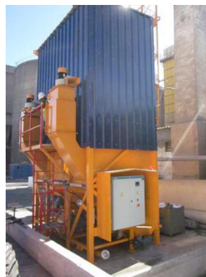
Nova instalação (silo) de armazenagem e alimentação de combustíveis alternativos ao queimador principal (MTD 12.a-c e 12.e)
