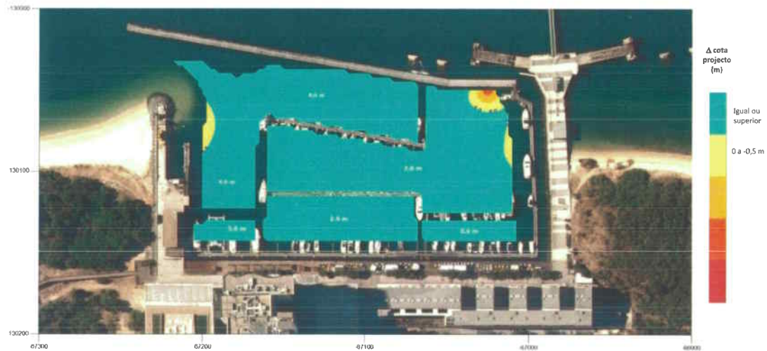
Figura 22. Marina de Troia: Batimetrias em relação aos valores de projeto (à data de 03/1/2022). A azul, profundidades iguais ou superiores às de projeto; amarelos e laranjas, rebaixamento em relação às batimetrias de projeto.
