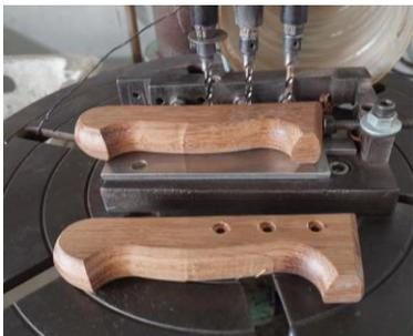
Fase em que ocorre o corte da madeira e maquinação dos cabos. A madeira é fresada e lixada. São abertos os cabos para se poder inserir as lâminas e finalmente são furados os cabos para se poder aplicar os rebites.
