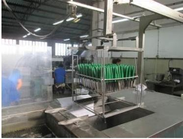
Após o polimento as lâminas ficam gordurosas, pelo que é necessário proceder à lavagem com água e detergente numa máquina de ultra-sons.
