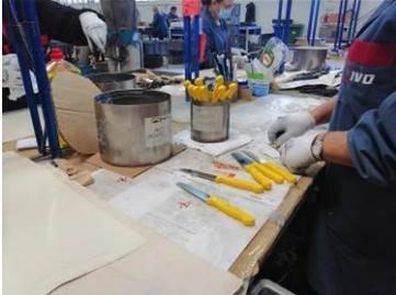
Fase onde acontece a limpeza da lâmina e cabo (se este for de madeira ou com acabamento) com água e sabão em máquina de ultra-sons ou com detergente em limpeza manual.
