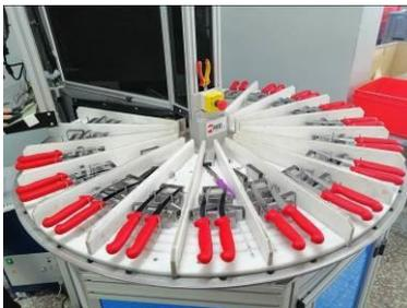
Após o polimento as lâminas ficam gordurosas, pelo que é necessário proceder à lavagem com água e detergente numa máquina de ultra-sons. Seguidamente são marcadas de acordo com as especificações do cliente.
