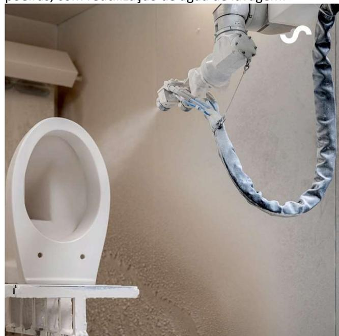
Imagem 10: Linha de produção cerâmica – Robô de Vidragem
